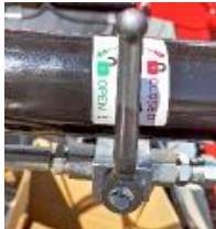
HANDBETÄTIGTES VENTIL ZUR ABSTIEGSSPERRE DES HEBEZYLINDERS
